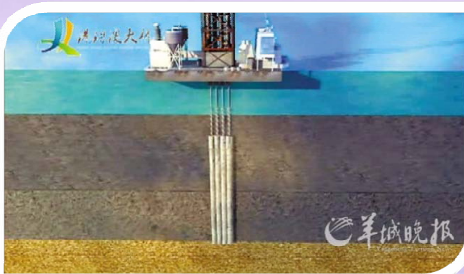
海底隧道地基施工中打入擠密砂樁
